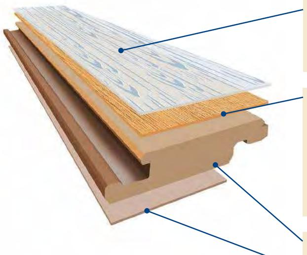
**Балансирующий слой** – специальная высокопрочная бумага, пропитанная смолой, основная функция – компенсация остаточных напряжений, поддержание стабильности размеров и защита от проникновения влаги.
